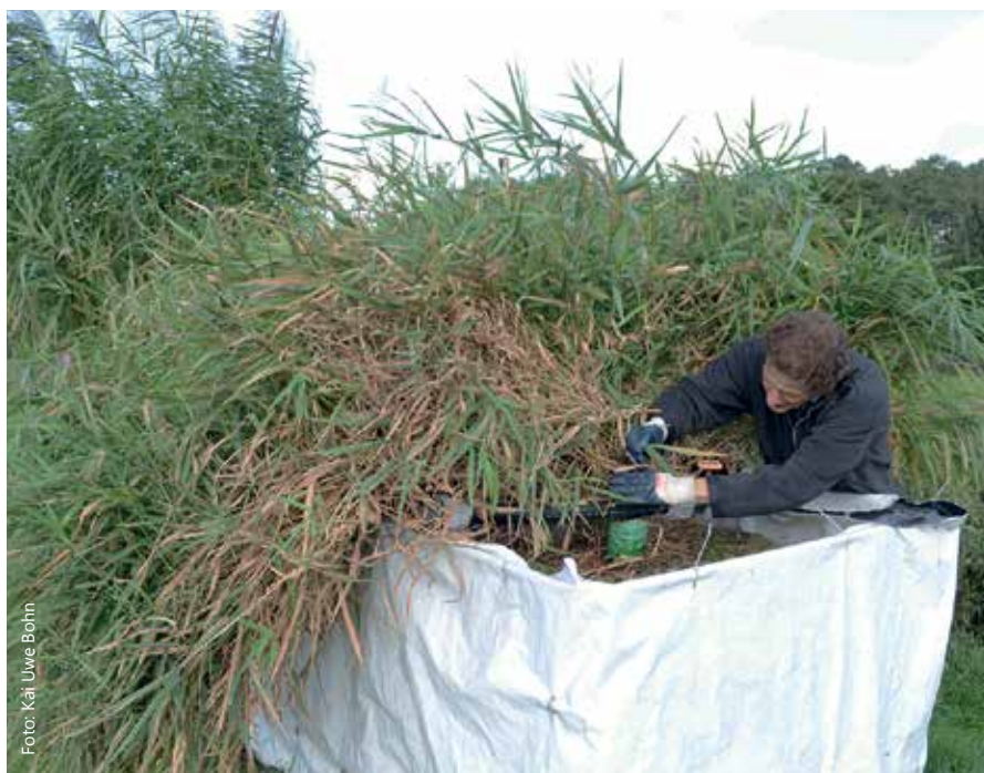
Durch Versuche mit Lysimetern ermittelte das Forscherteam der Uni Bremen die Wechselwirkungen und Stofftransporte zwischen Pflanzen, Boden und Abwasser. The research team at the University of Bremen conducts experiments with lysimeters to investigate the interactions and transport of substances between plants, soil, and the waste water.
