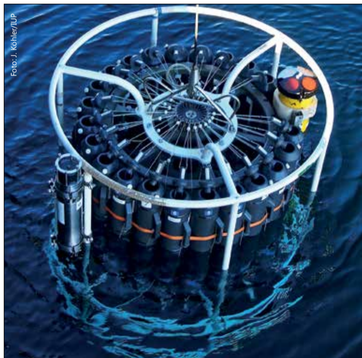
Im SFB/Transregio benutzen die Bremer Forscher dieses Mehrzweckgerät der Arbeitsgruppe von Professorin Monika Rhein. Es enthält Sensoren, die wichtige Umweltparameter von der Oberfläche bis zum Ozeanboden messen.
