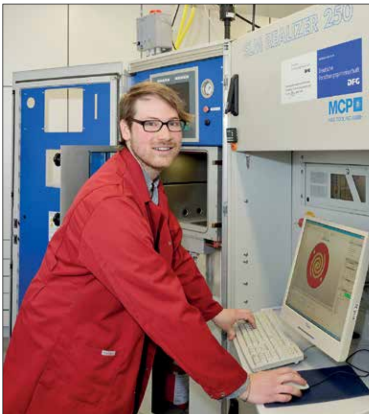
Frederik Feuerhahn vor dem SLM Realizer 250, der Metallpulver mithilfe eines Lasers schmilzt.
