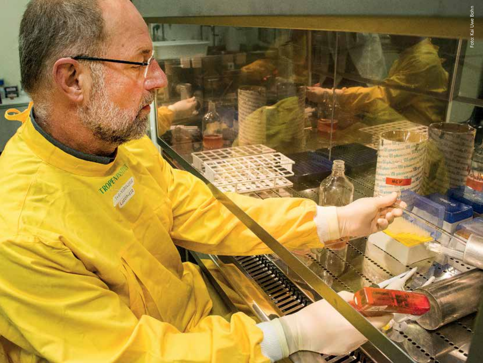
Schutzanzug, Handschuhe, Luftschleuse: In der Virologie ist Sicherheit wichtig. Hier agiert Professor Andreas Dotzauer an einer speziellen Werkbank. Eine elektronische Regelung verhindert, dass Luft von innen nach außen dringt – und umgekehrt.
