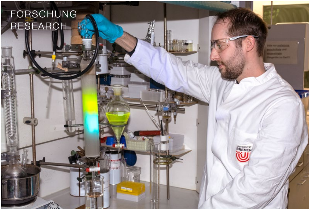
IACK-Mitarbeiter Rasmus Stichauer trennt mit Hilfe der Säulenchromatographie Mischungen neuer Leuchtstoffe auf.
