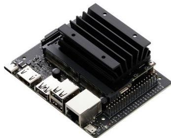
Bei den *Jetson Boards*, einer Produktfamilie von *Nvidia*, handelt es sich um eingebettete Systeme, die vorrangig dazu dienen, Algorithmen des Maschinellen Lernens möglichst effizient auszuführen. Hierzu verfügt die *Jetson* Hardware über eine spezielle Architektur (sog. *CUDA cores*) zur optimierten und beschleunigten Ausführung von KI-Verfahren.
