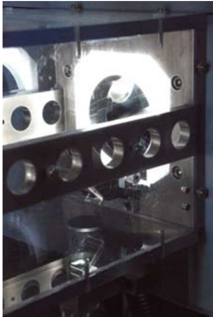
Ein Spiegelsystem lenkt das Sonnenlicht direkt in das Spektrometer.
