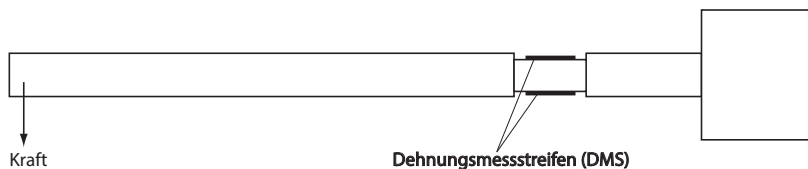
Abbildung 2: Biegebalken zur Kraftmessung
