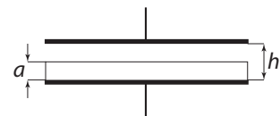
Abbildung 4: Kondensator mit eingelegetem dielektrischem Material
