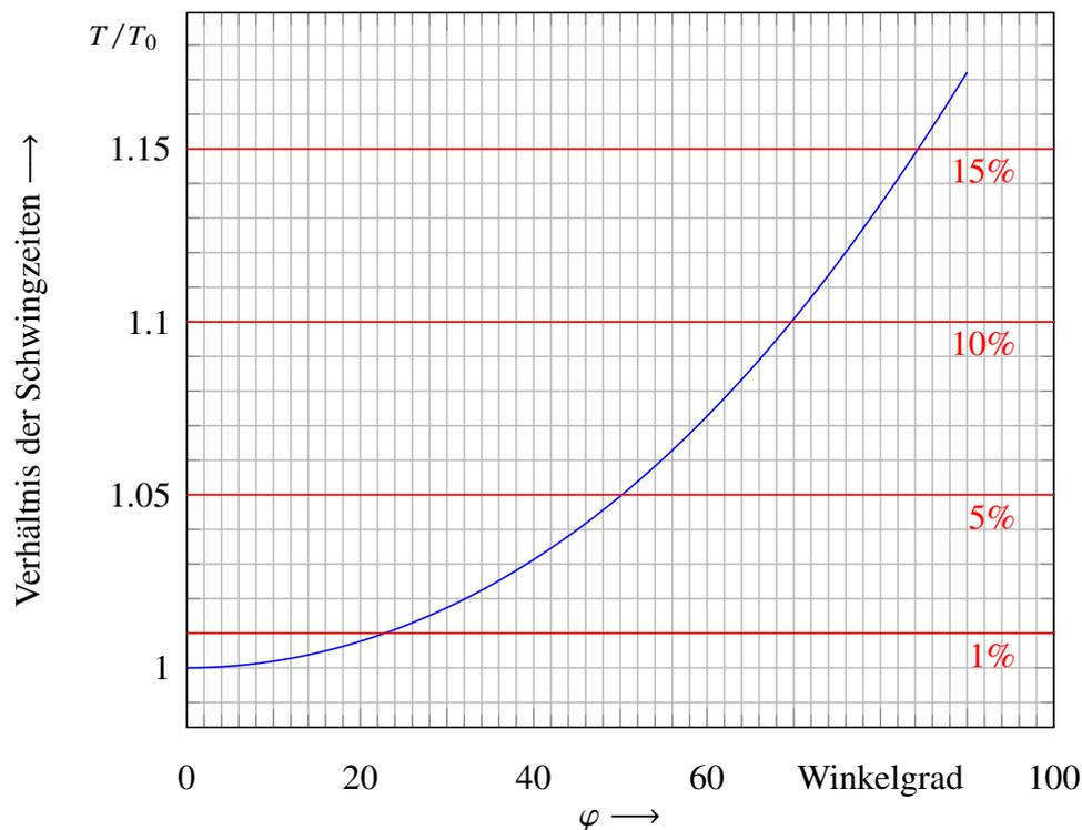
Abbildung 2: Abhängigkeit von  $T/T_0$  vom maximalen Auslenkungswinkel  $\varphi$ , wobei  $T_0 = 2\pi \sqrt{\frac{L}{g}}$  ist.
