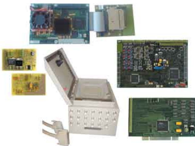
Abb. 2: Komponenten des Datenlogger und InDiaSys 2.0 Systems ohne Sensorik
