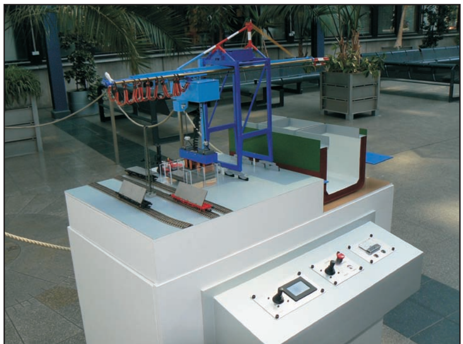
Abb. 2: Foto des Kranmodells - mit Hilfe des Joysticks können Bleche mit Hilfe des Magnethebesystems in den Schiffsrumpf geladen werden.
