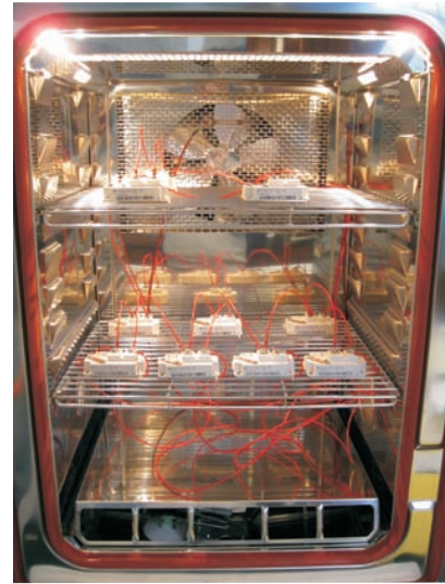
Abb. 2: Testaufbau in der Klimakammer des Teststands
