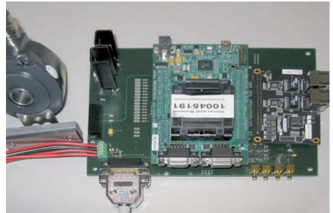
Abb. 2: Drehgeber und DSP-Board mit EtherCAT-Briefmarke
