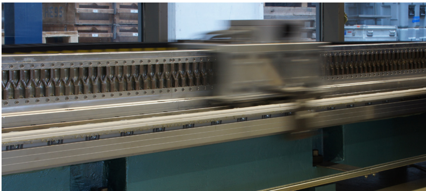
Abb. 1: Foto des Transversalfluss-Linearantriebs im Labor des IALB
