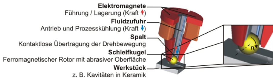
Abb. 1: Aufbau GrindBall-Modul
