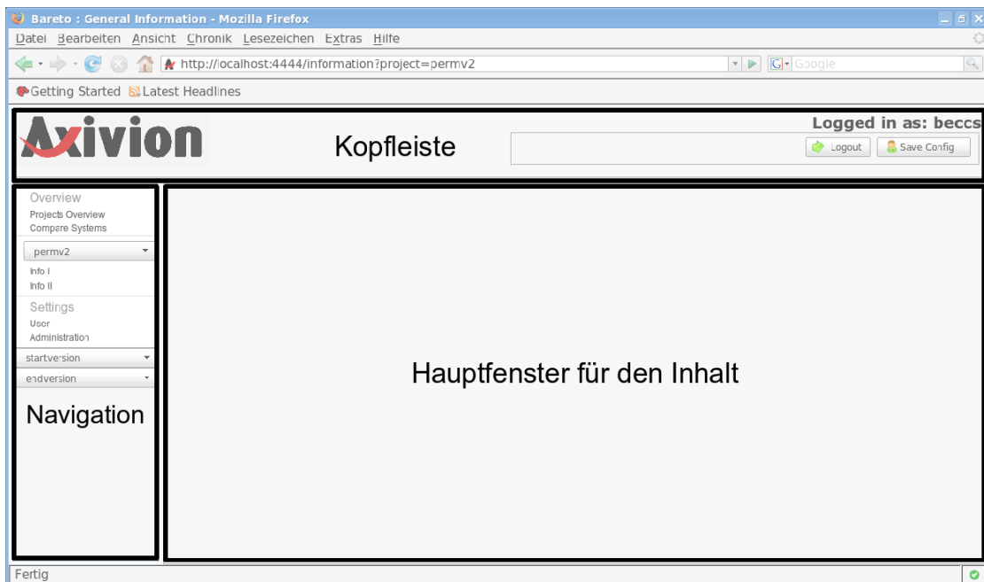
Abbildung 4.3: Aufbau der grafischen Oberfläche
