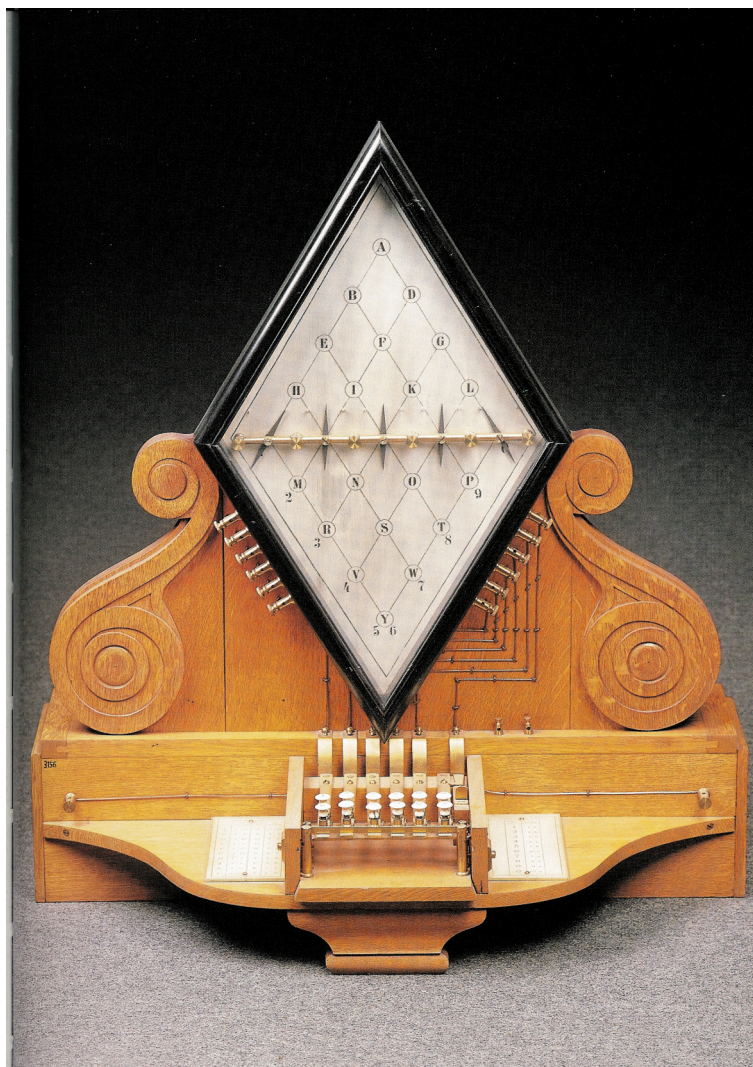
Fünfnadeltelegraph mit Ablese-Display von Wheatstone und Cooke von 1837 (nach Reuter, Telekommunikation, S. 47)
