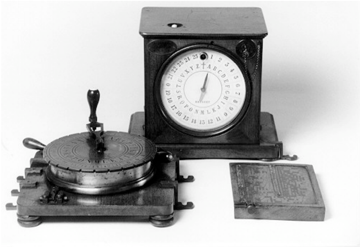
Zeigertelegraph von François Clément Breguet von 1844 nach: http://www.lgl.lu/museedelaphysi/TelegrapheBreguetCadran/TelegrapheBreguetCadran.htm
