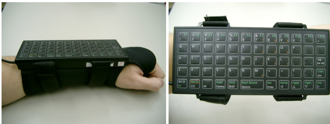
Abbildung 3: links: Xyberkey TM -Tastatur mit Befestigung, rechts: Tastaturlayout
