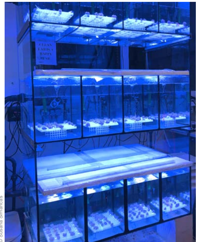
Abb. b: Die experimentelle Aquarienanlage der Abteilung Marine Ökologie im UFT. Hier werden die Auswirkungen von Umweltfaktoren auf physiologische Prozesse (z. B. Wachstum, Kalkbildung, und Photosynthese) in Weichkorallen untersucht. Diese Aufnahme entstand während der morgendlichen Beleuchtung der Aquarien mit künstlichem Blaulicht, welches die natürlichen Lichtverhältnisse bei Morgendämmerung imitiert.
