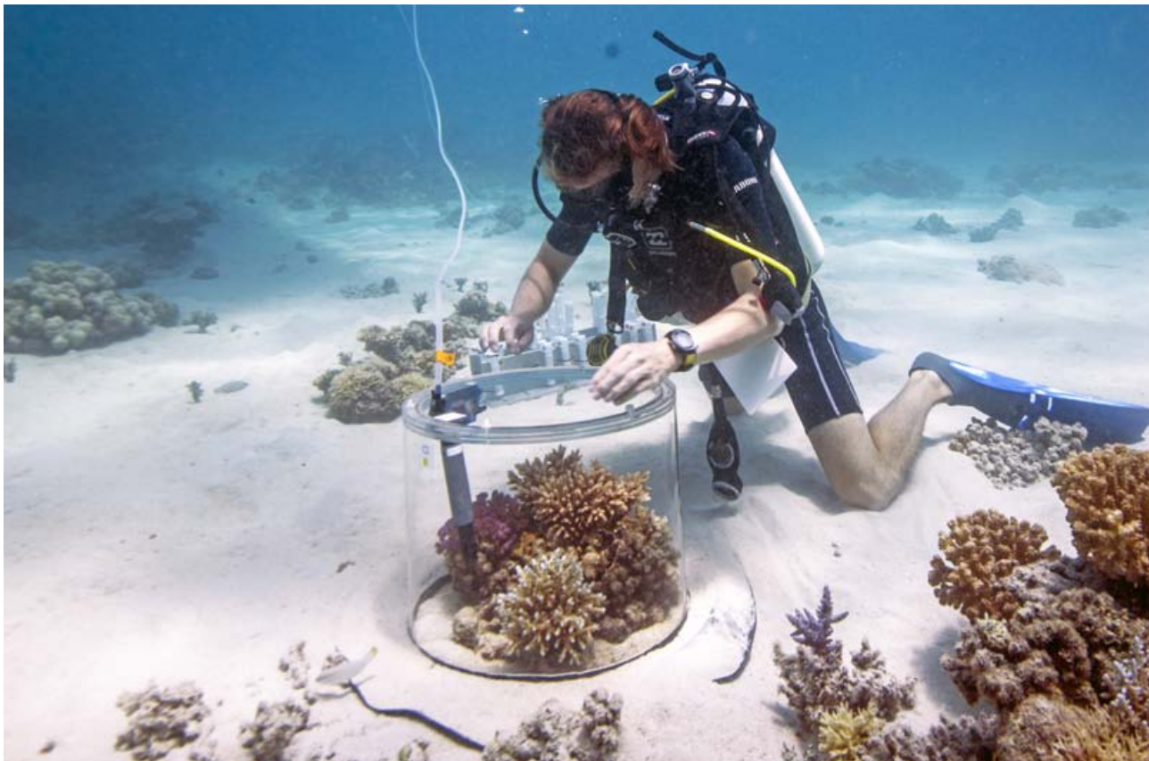
Abb. a: Aufbau einer Feldstudie mit transparenten Kunststoffkammern zur kontinuierlichen Messung von Nährstoffkreisläufen (Material- und Energietransport) zwischen der Wassersäule und den am Boden lebenden Gemeinschaften eines Korallenriffs im zentralen Roten Meer.
